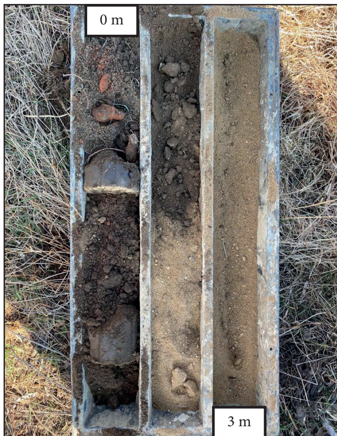
Geologický profil vrtu S3
