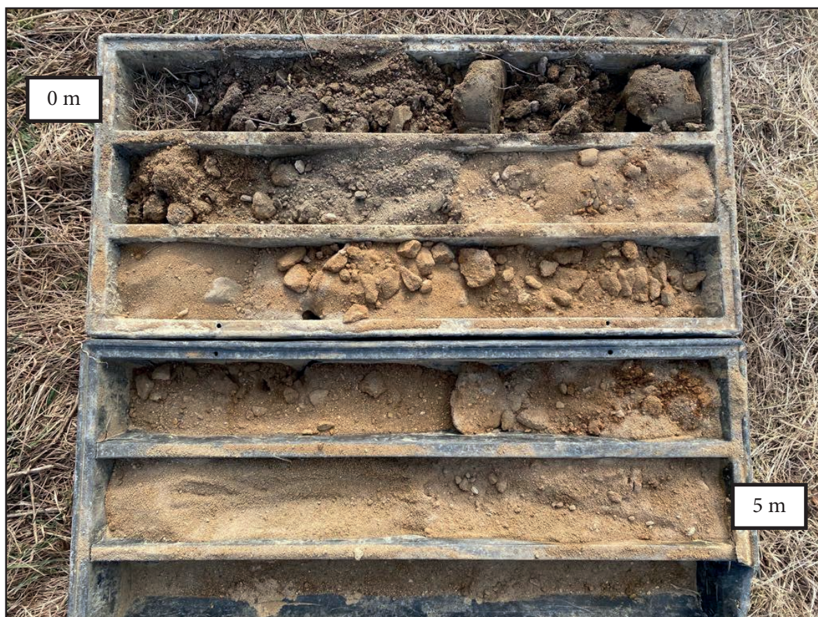
Geologický profil vrtu S2
